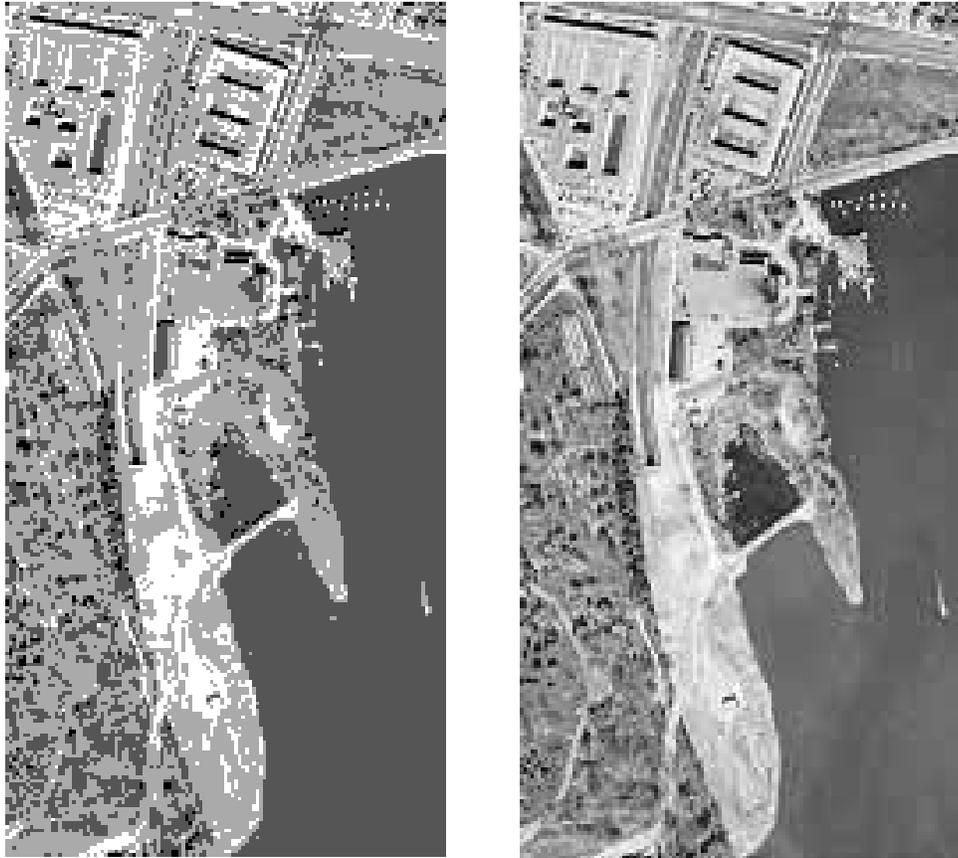
Figura 9: Imágenes con el mismo escenario, resolución radiométrica de 2 bits (izquierda) y 8 bits (derecha).
